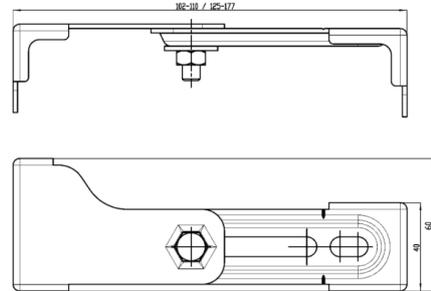
Soportes de pared AQUAFIX para instalación sobre la pared. Permite ajustar bastidores AQUAFIX sobre mampostería o delante de paredes huecas. Profundidad ajustable, para montaje individual, acero galvanizado. Incluye material de fijación. La presentación incluye 2 piezas.
